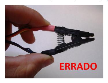
Ao utilizar a pinça evite de segurá-la apoiando os dedos próximos ao cabo, pois assim a pressão fica sobre o conector de encaixe e pode quebrá-lo.
