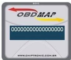
Neste caso deve estar aparecendo o campo para digitar os dados a gravar, como na figura ao lado. Pressione sucessivamente a tecla VOLTA, até o primeiro dígito. Em seguida mantenha a tecla VOLTA pressionada por alguns segundos. Soará um bip contínuo e o ObdMap voltará ao menu de seleção do ID a escrever.
