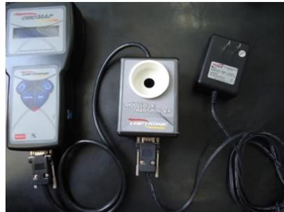
**3 . Conecte a fonte do ObdMap a uma tomada 110V ou 220V.**
