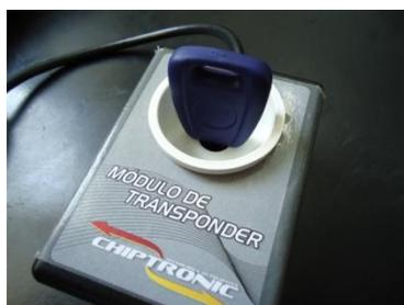
Se o transponder estiver contido em uma chave posicione a lâmina para baixo e introduza no orifício do fundo do copo da antena até que a cabeça da chave assente no fundo do copo.
