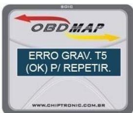
**Solução:** Durante a gravação, a comunicação do Módulo de transponders com o transponder em gravação pode sofrer eventuais interferências, causando erro. Tente repetir a gravação seguindo as recomendações do item 5.1.
