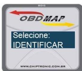
O display do ObdMap deve mostrar uma mensagem idêntica a da figura ao lado . Este já é o menu da Carga básica do Módulo de transponders . Para sair desta função basta pressionar sucessivamente a tecla **VOLTA**.
