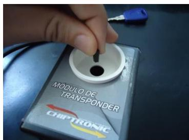
No caso de transponder fora da chave o mesmo deve ser posicionado dentro do copo da antena, na vertical (perpendicular ao plano da antena) e na região central do copo. O transponder pode ser segurado com a mão durante a operação.
