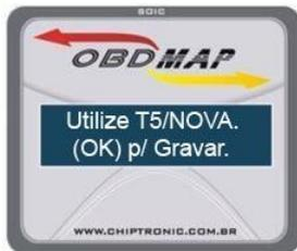
Ao pressionar OK, aparecerá a mensagem da figura ao lado, indicando que tipo de transponder deve ser utilizado para produzir a cópia. Posicione um transponder do tipo indicado e pressione OK.
