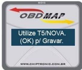
Após ajustar os valores dos dados, ou após selecionar o ID 20 e pressionar OK, aparecerá a mensagem da figura ao lado, indicando qual tipo de transponder deve ser utilizado. Posicione um transponder do tipo indicado e pressione OK.
