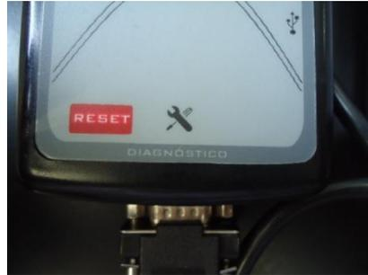
**2 . Conecte o cabo da fonte de alimentação no conector do Módulo de transponder (conector DB9)**
