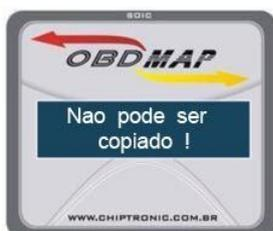
**Solução:** Esta mensagem surge quando se tenta copiar um transponder de um tipo que pode ser identificado, mas não copiado. É o caso do T48 (ID48) usado no sistema CODE II FIAT. A criptografia deste transponder é virtualmente impossível de ser quebrada e também não há no mercado um transponder capaz de emulá-lo.
