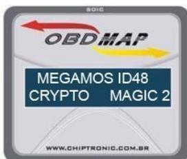
Após ler um transponder ID 48, na primeira linha do display aparece a indicação do fabricante e ID. A segunda linha mostra tratar-se de um transponder com criptografia e informa se é Magic 1 ou Magic 2.
