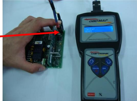
Depois de feita a raspagem nos terminais da memória soic onde será feita a leitura, use a pinça soic e conecte-a na memória soic e selecione a seguinte sequência no menu do OBDMap:
