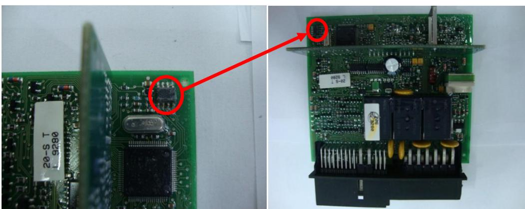
Depois de localizado a memória soic no modulo de conforto é necessário fazer uma raspagem com um estilete nos terminais da mesma, para que o verniz que protege a placa contra oxidações não isole os terminais da pinça dos terminais da memória soic.
