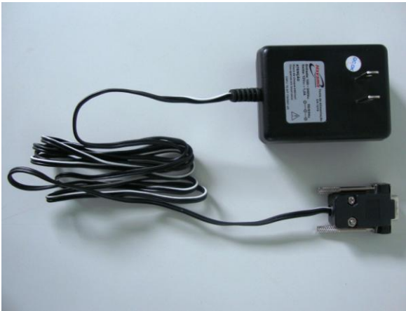
Cabo OBD Universal e Adaptador A1. Realiza programação de chaves via diagnóstico.
