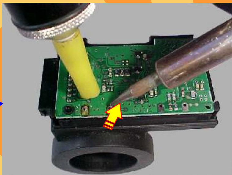
Removendo a solda da antena do Imobilizador GM Opel 2
