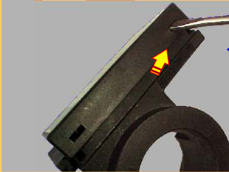
Removendo a tampa do Imobilizador GM Opel 2
