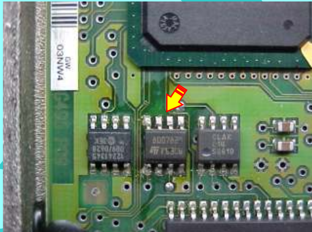
Central Delphi Multec HSFI 2.3. Aplicando a pinça soc 8 para Reset da Central
