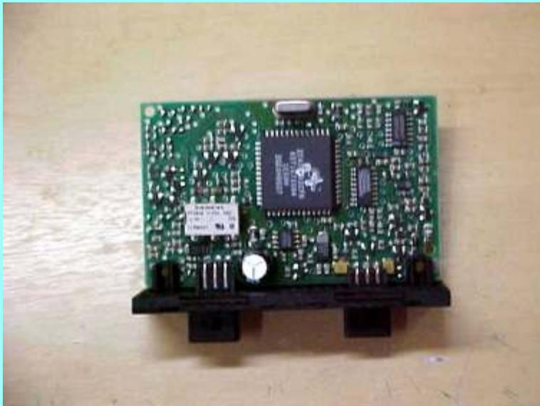
Visão geral da Placa do imobilizador Desmontada.
