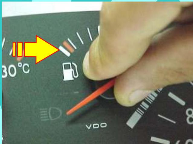
Não entortar o ponteiro, pois pode danificar o seu eixo e comprometer o marcador.
