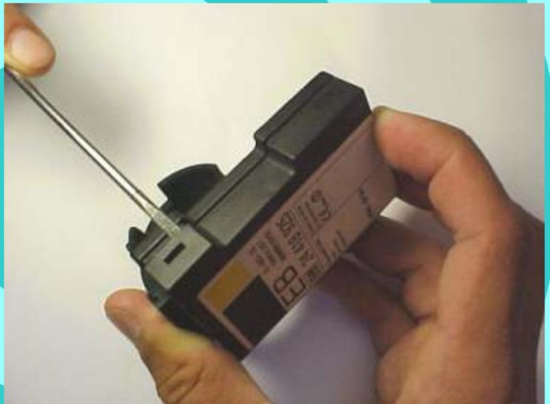
Retirando a placa de circuito do imobilizador GM 1
