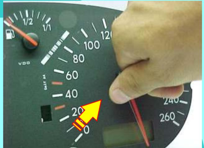
**COLOCANDO DE VOLTA OS PONTEIROS**
