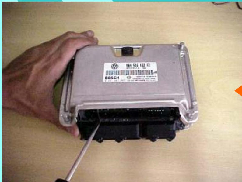
Após ter retirado os parafusos, retire a tampa (cuidado pois na tampa existe um material isolante que pode dificultar a retirada da mesma).
