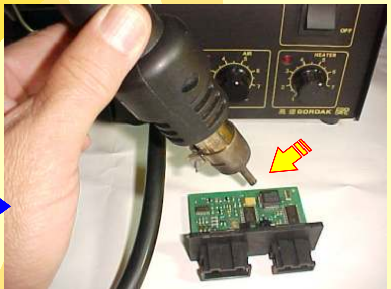
Regulando a estação de ar quente para retirar a solda do Microprocessador
