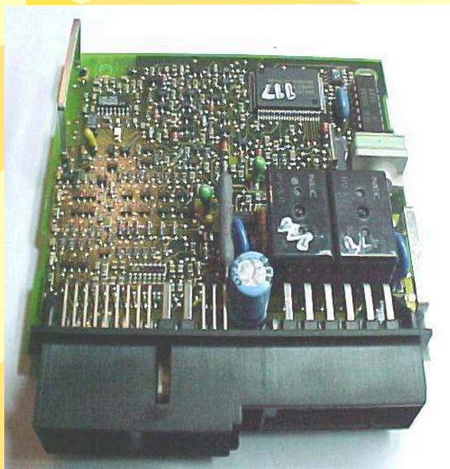
Localização da memória (SMD 93C46) a ser programado da Unidade do alarme do GM Vectra
