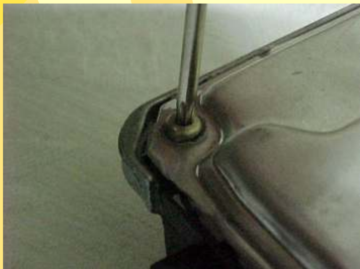
Removendo os parafusos da tampa da Central Magneti Marelli IAW 59 FBUN Fiat Fire
