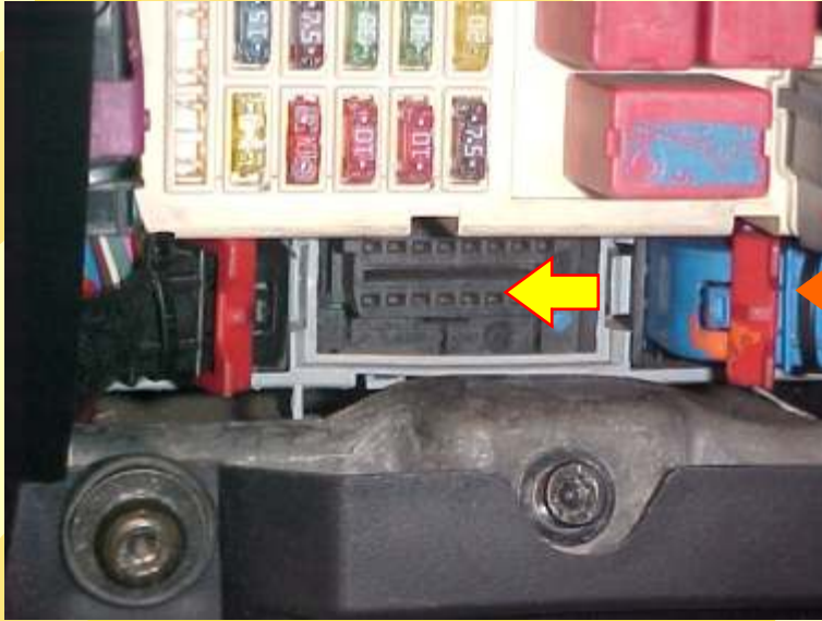
Localização do conector de diagnostico do Stilo 2.4 Local do lado esquerdo da coluna de direção
